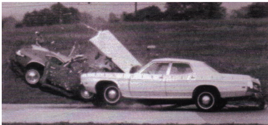
Snímek zkušebního testu demonstruje, jak důležitá je pro posádku velikost a váha vozu. Plnohodnotný fullsize Ford Galaxie doslova rozmetl Ford Pinto s lehkou samonosnou karoserií.
