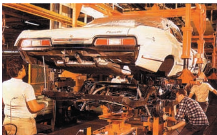
Dělníci usazují nalakovanou karoserii Impaly 1967 na již zkompletovaný rám s motorem
